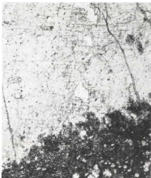
Obr. 6. Celestín s charakteristickou štiepatelnosťou v reiflinskom vápenci postihnutom slabou dolomitizáciou (nedokonalé biele klenčeky v čiernom podklade) — vrchný anis. Vrt Kuklov—3, 4998 — 4999 m, zv. 48 x
