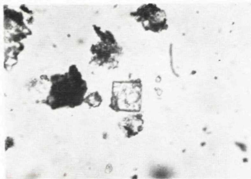
Obr. 3. Fluorit z nerozpustného zvyšku hnedastosivého dolomitu so slabou dedolomitizáciou. Spodná časť oponických vrstiev — vrchný karn. Vrt Kuklov—3, 3678 — 3679 m, zv. 470 x
